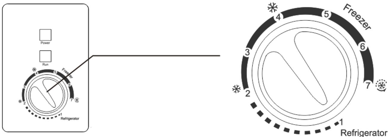
Необходимая температура в морозильном ларе устанавливается и контролируется с помощью панели управления. Панель управления представлена ручкой термостата и индикаторами. Регулировка температуры осуществляется с помощью термостата в пределах от +10°C до -24°C.
