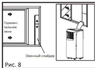
ПРИМЕЧАНИЕ: Если длина оконного проема меньше, чем минимальная длина комплекта оконного слайдера, отрежьте конец без фиксатора достаточно коротко, чтобы он вошел в оконный проем. Никогда не вырезайте отверстие в комплекте оконного слайдера.
