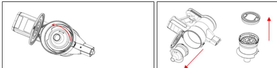
4. Тщательно промойте фильтр предварительной очистки, циклонный блок и контейнер для пыли водой, а затем отложите минимум на 24 часа для полной просушки.
