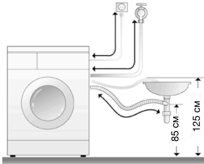
Расположение сливного шланга должно обеспечивать разрыв струи при сливе (конец шланга не должен быть опущен в воду).
