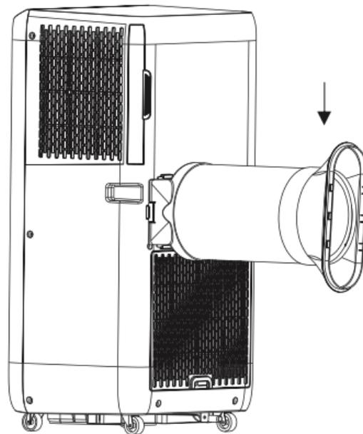
4. Закрепите соединитель на заднем выпускном отверстии кондиционера.
