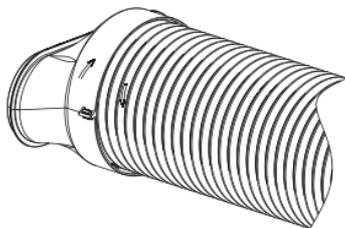
3. Вставьте оба конца выбросного воздуховода в соединитель и выпускное сопло и зафиксируйте.
