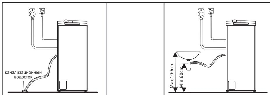
Гофрированный сливной шланг должен быть подключен к сливу на высоте 60-100 см от пола.
