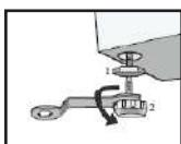
После того как прибор будет установлен в место предполагаемого использования, отрегулируйте его по уровню с помощью инструмента, затем зафиксируйте положение ножек с помощью контргайки. Стиральную машину следует устанавливать на твердой и ровной поверхности.
