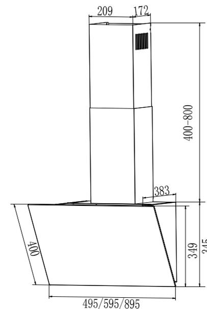
Рис. 1 Внешний вид кухонной вытяжки и схема размеров
