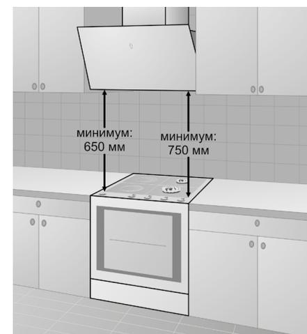
Рис. 6 Минимальные расстояния от газовой, электрической плиты
