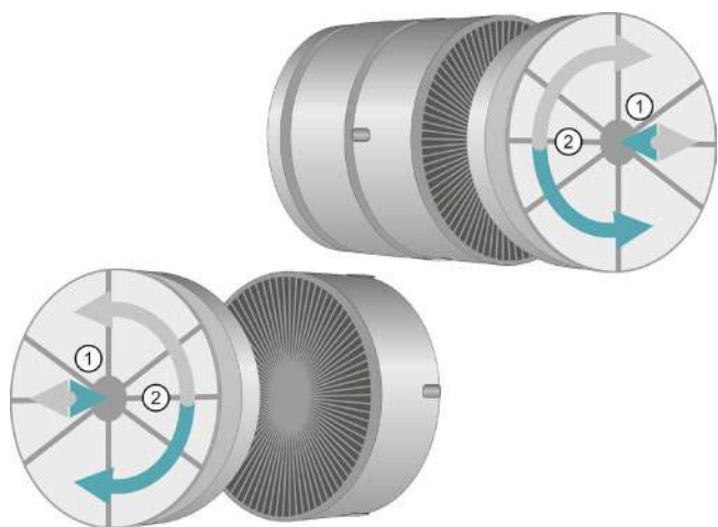
Рис. 14 Установка угольного фильтра
