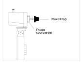
Установите решетку и закрепите ее гайкой, поворачивая ее по часовой стрелке.
