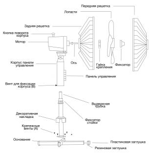
Открутите гайку крепления, поворачивая ее против часовой стрелки.
