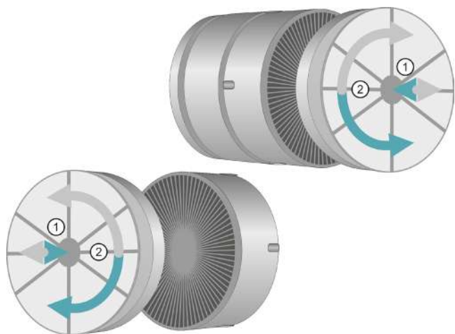
Рис. 14 Установка угольного фильтра
