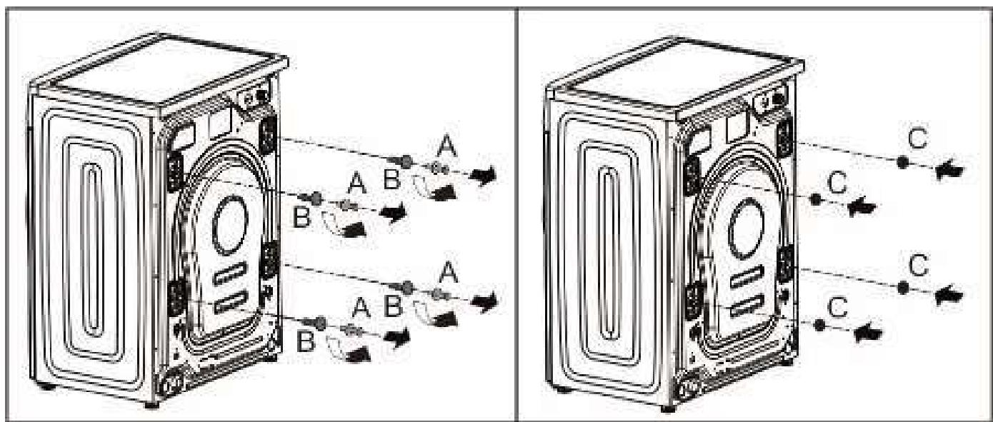
**Сохраняйте транспортировочные болты!** Они могут потребоваться при возможной транспортировке машины в будущем. В этом случае установите транспортировочные болты в обратной последовательности.
